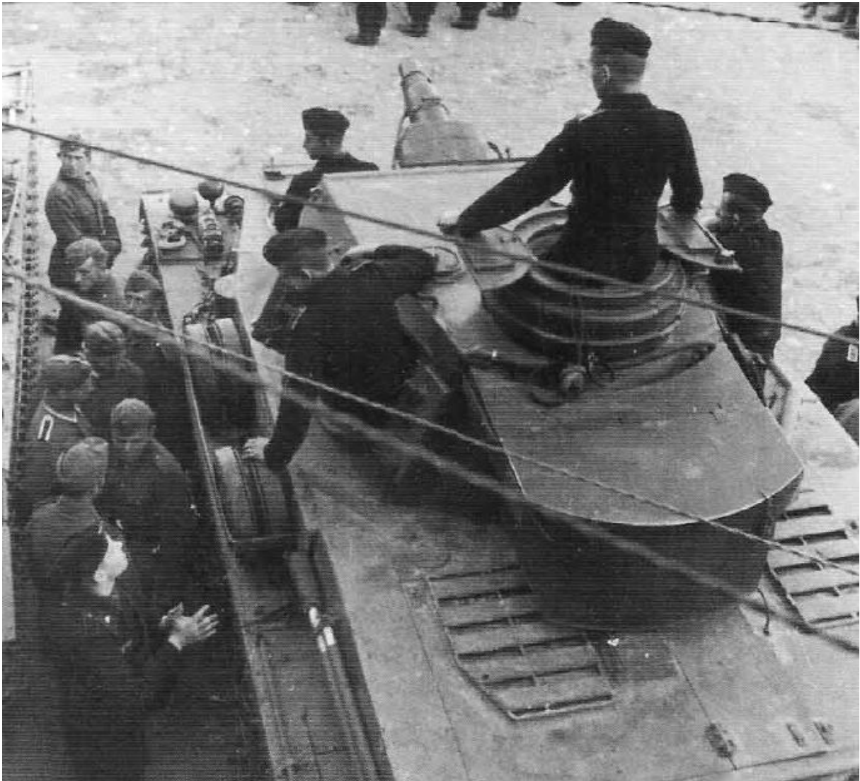
Der Motorraum erhielt eine neue obere Abdeckung mit zwei Kühlerlüftungsgittern. Quelle: K. Hjemstad Panzer IV
